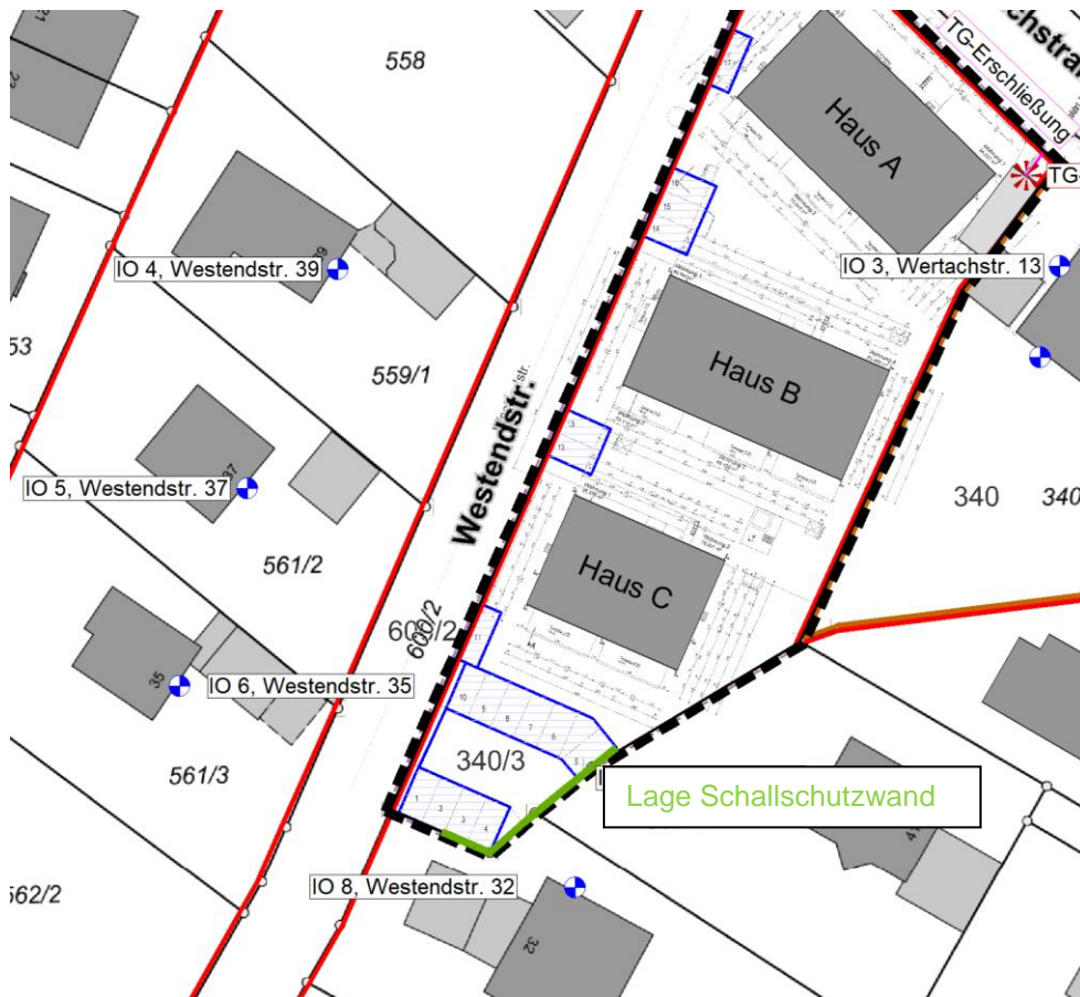
Abbildung 3: Plangebiet mit Kennzeichnung der 2 m hohen Lärmschutzwand
